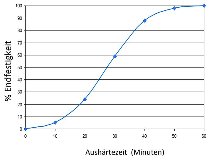
Die grafische Darstellung zeigt den typischen Aufbau der Festigkeit bei der Verklebung von Probestücken, welche bei 23°C verklebt wurden. Wird die Temperatur um 8°C erhöht, halbiert sich die Aushärtezeit. Niedrigere Temperaturen haben eine langsamere Aushärtung zur Folge.
