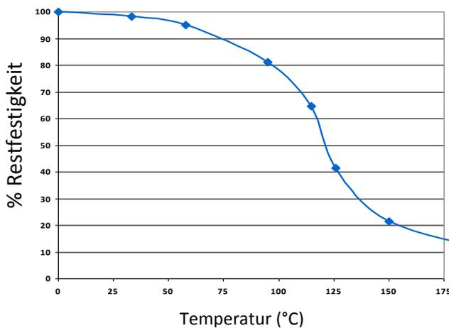
TA4300 kann bei geringen Belastungen kurzzeitig auch höheren Temperaturen ausgesetzt werden (z.B. bei Einbrennlack- oder Schwall-Löt-Verfahren). Niedrigste Temperatur bei Endfestigkeit: -40°C (abhängig von den verwendeten Materialien).
