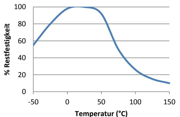
„Hitzebeständige“ Scherfestigkeitsversuche wurden auf Weichstahl durchgeführt. Aushärtung bei Raumtemperatur über 24 Stunden. Vor der Testversuchen wurden die Teile über 30 Minuten auf der Testtemperatur gehalten.
