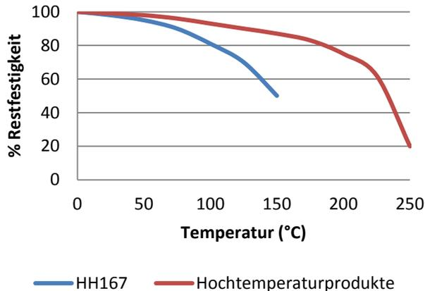
*“Hitzebeständige” Losbruchfestigkeit wurde bei verzinkten Schrauben M10 gemäß ISO 10964 geprüft. Aushärtung bei 23°C über 24 Stunden. Vor den Testversuchen wurden die Teile über 30 Minuten auf der Testtemperatur gehalten.*
