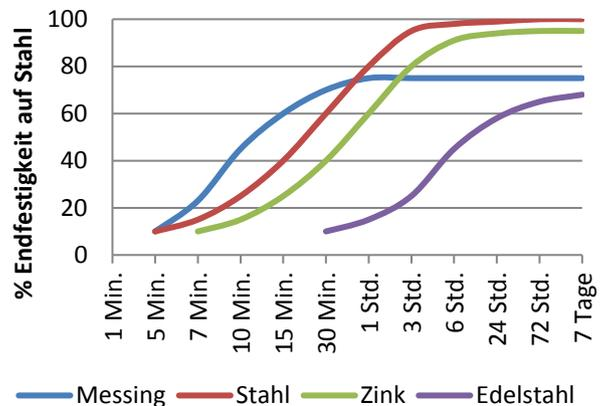
\* Dies sind typische Werte auf Stahlflächen bei 23°C. Kupfer und Kupferlegierungen beschleunigen die Aushärtung, inaktive Oberflächen (wie rostfreier Stahl oder Zink) sowie niedrige Temperaturen und große Spalte verlängern die Aushärtezeit. Um die Aushärtezeit zu verringern, kann der Oberflächenaktivator Permabond A905 verwendet oder die Verklebung erwärmt werden.
