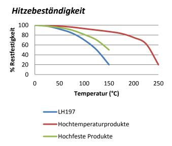
"Hitzebeständige" Losbrechfestigkeit wurde bei verzinkten Schrauben M10 gemäß ISO 10964 geprüft. Aushärtung bei 23°C über 24 Stunden. Vor den Testversuchen wurden die Teile über 30 Minuten auf der Testtemperatur gehalten.
