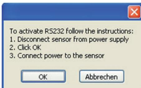
Abbildung 2: Anweisungen - Umstellung von CANopen-Modus auf RS232-Modus
