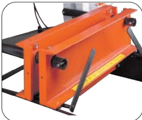
Tiefe zwischen 102 und 686 mm einstellbar; mit Arretierungsbolzen gesichert.
