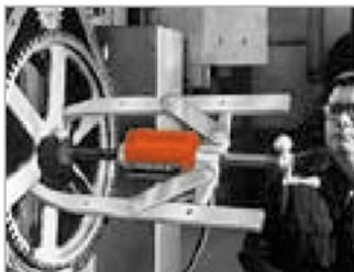
Ein 2-armiger Abzieher greift durch die Speichen eines Zahnrads hindurch, um die Nabe zu fassen. Für die Hydraulikkraft sorgt eine Handpumpe.
