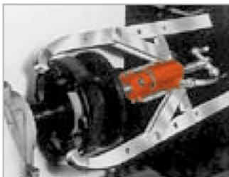
Eine flexible Kupplung wird mit einem 2-armigen Abzieher von einer Elektromotorwelle abgezogen.
