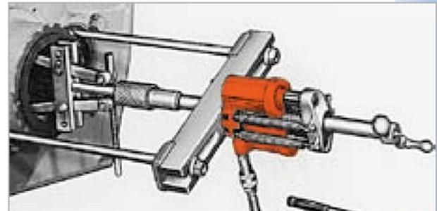
Push-Puller\*-Abzieher (Druckkraft 50 Tonnen) mit Innenabzieher bei der Demontage einer Antriebswellendichtung.
