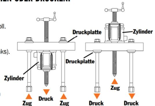
**Modelle und Druckkräfte** – Jeder Push-Puller®-Abzieher ist für eine bestimmte Druckkraft ausgelegt. Die Druckkraftangaben beziehen sich auf die Standard-Abziehstangen bei Zugbelastung. Bei Verwendung von längeren Abziehstangen und Druckbelastung reduziert sich die Belastbarkeit. Wählen Sie daher stets den stärksten Abzieher und die je nach Einsatzbedingungen entsprechend kürzesten Abziehstangen.
