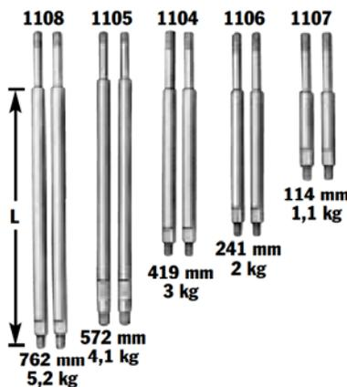
**HINWEIS:** L = Abziehstangenlänge: 114 mm, 241 mm, 419 mm, 572 mm und 762 mm; bei der Verwendung von Endkappen 124 mm von der Abziehstangenlängen abziehen, um die Abziehtiefe zu ermitteln.
