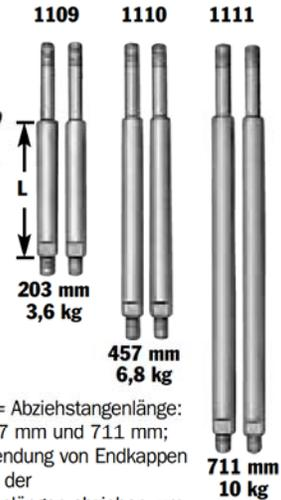
**Hinweis:** L = Abziehstangenlänge: 203 mm, 457 mm und 711 mm; bei der Verwendung von Endkappen 149 mm von der Abziehstangenlängen abziehen, um die Abziehtiefe zu ermitteln.
