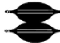
**Zur Vergrößerung der effektiven Hubhöhe maximal zwei Kissen aufeinanderstapeln.**
