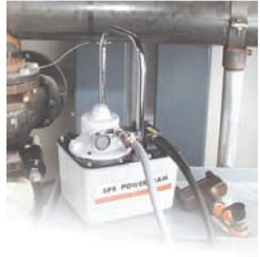
PA17-Pumpe im Einsatz mit einem Flanschspreizer.
