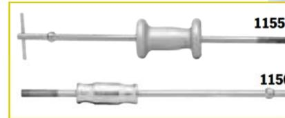
**Schlagabzieher** – Zum Abziehen von Zahnrädern, Lagern, äußeren Kugellagerringen, Dichtungen usw. Kann zwei- oder dreiarstig für Innen- oder Außenabzieharbeiten eingesetzt werden. Beide Werkzeuge mit 5/8-Zoll-18-Endgewinde zur Montage von Zubehör und Adaptern.
