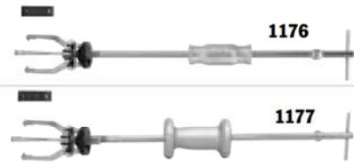
**Schlagabzieher mit Innenabzieher** – Kombination aus Schlaghammer und Innenabzieher Nr. 1152 für den Ausbau von Dichtungen, äußeren Kugellagerringen und Lagerschalen aus Sacklochbohrungen.
