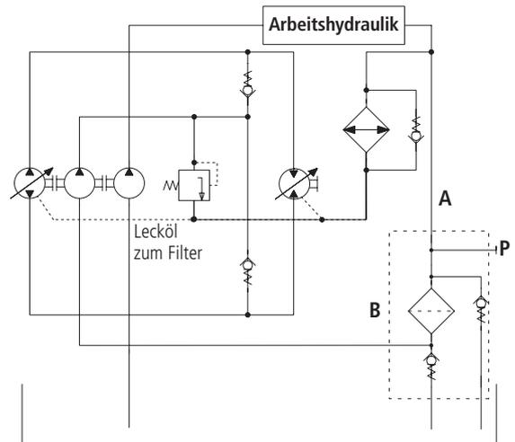
Der gesamte im Hydrostaten durch Abrieb erzeugte Schmutz wird sofort ausgefiltert und somit nicht von der Pumpe des offenen Kreises angesaugt.
