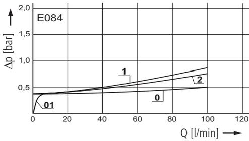
Druckverlust in Abhängigkeit von der **kin. Viskosität**
