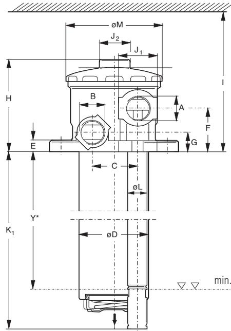
Ausführung mit Nachsaugventil und Schutzsieb
