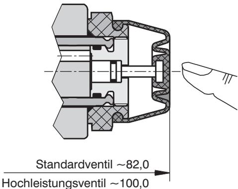
Bezeichnung **M5** - Betätigung durch Hineindreihen der Innensechskantschraube, Innensechskant 2,5
