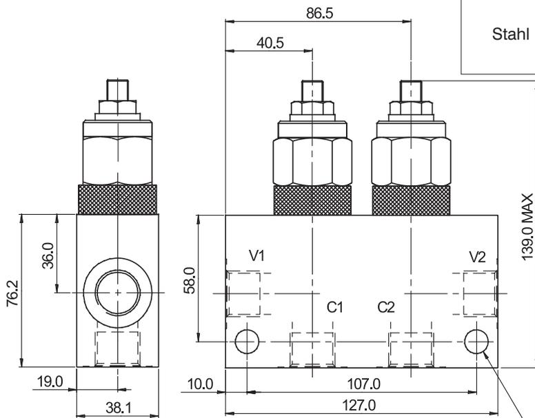
2x Durchgangsbohrung Ø11
