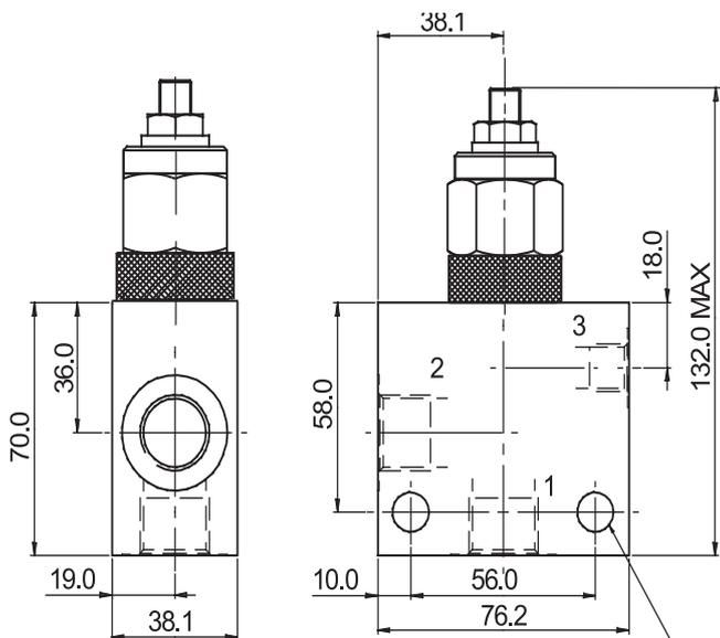
2x Durchgangsbohrung Ø11
