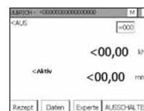
SPS Display Funktionstasten und Scroll-Listen als Bedienung
