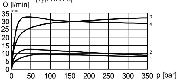
$\Delta p = f(Q)$  Druckverlust-Volumenstrom-Kennlinie ( $s = 100\%$ )
