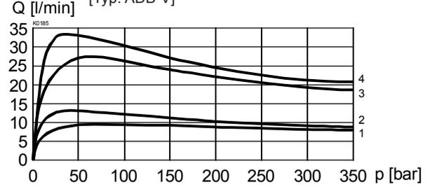
$\Delta p = f(Q)$  Druckverlust-Volumenstrom-Kennlinie ( $s = 100\%$ )
