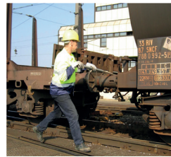
Abb. 2: manuelles Aushebeln der Schraubenkupplung
