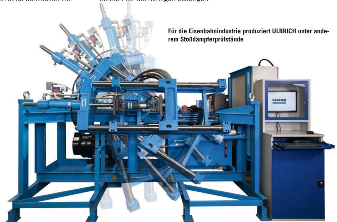
Für die Eisenbahnindustrie produziert ULBRICH unter anderem Stoßdämpferprüfstände
